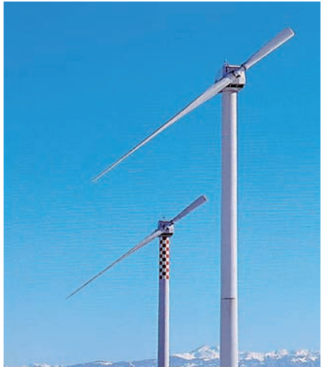
Figura 1.14 - Aerogeneradores de una sola pala provista de contrapeso
