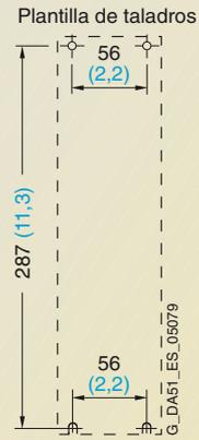
Fijación con tornillos M4
