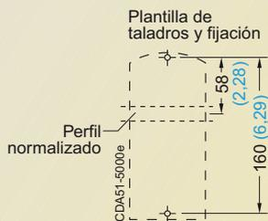
Fijación con 2 tornillos M4, 2 tuercas M4, 2 arandelas M4 o abrochado en perfil
