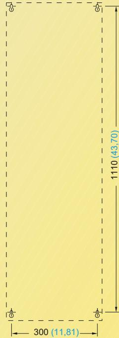
Fijación con 4 tornillos M8, 4 tuercas M8, 4 arandelas M8
