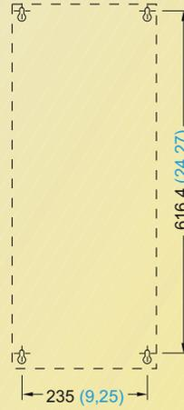
Fijación con 4 tornillos M8, 4 tuercas M8, 4 arandelas M8
