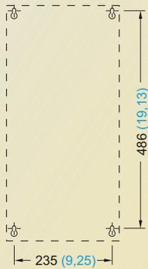
Fijación con 4 tornillos M8, 4 tuercas M8, 4 arandelas M8
