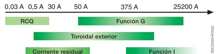
La figura representa la función del relé electrónico o dispositivo que debe utilizarse en función del valor de la corriente de defecto.
