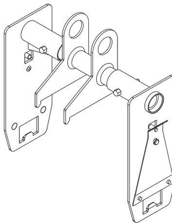
Este accesorio permite realizar la elevación del interruptor fijo y de la parte móvil de un modo fácil y seguro gracias a las chapas telescópicas.
