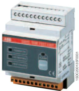
La unidad de control/monitorización “SOR Test unit” permite controlar el correcto funcionamiento de las diferentes versiones de los relés de apertura de la serie SACE Emax, para garantizar un elevado grado de fiabilidad tras el mando de apertura del interruptor automático.
