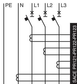
En caso de interruptores tripolares para sistemas con cinco cables (TN-S) se ha previsto la posibilidad de instalar transformadores de corriente en el neutro exterior.
