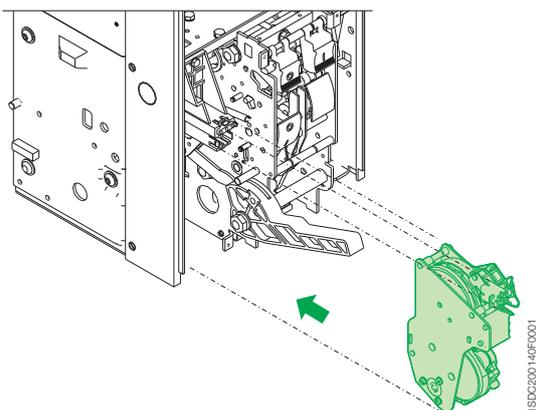
Realiza la carga automática de los resortes de cierre del mando del interruptor automático. Tras el cierre del interruptor automático, el motorreductor carga rápidamente los resortes de cierre.
