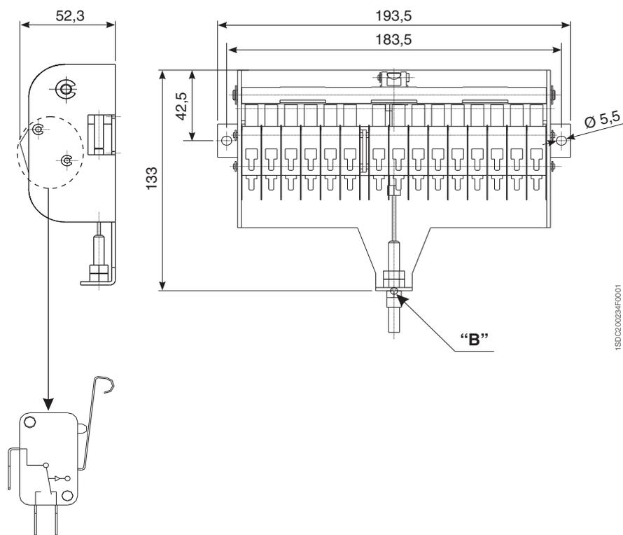
Desde el punto "A" hasta el punto "B" se dispone de un cable flexible de 650 mm de longitud.
