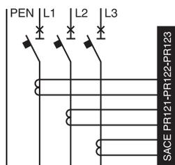
Para sistemas TN-C (el corte del neutro está prohibido ya que éste también efectúa la función de conductor de protección).
