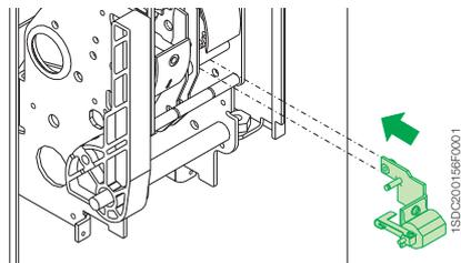
Sólo para interruptores tripolares, permite realizar la protección del neutro mediante la conexión con el relé de sobreintensidad. Se suministra bajo demanda.
