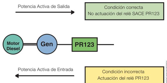
Cuando la potencia medida por el relé pasa a ser menor de cero, el relé PR123 actúa abriendo el interruptor automático y evitando de esta manera que se produzcan daños.
