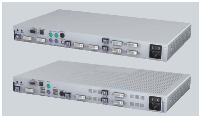
Extensor KVM FIBREVision, aparato emisor (arriba) y aparato receptor (abajo), vista posterior
