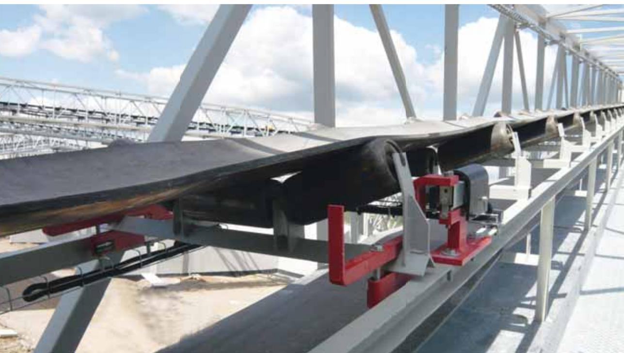
La estructura habitual de una báscula de cinta consiste en un puente de pesaje soportado por células de carga, un integrador de pesaje y un sensor de velocidad. Con la amplia gama de instrumentos de Siemens se dispone del sistema de pesaje óptimo para casi todo tipo de tareas. Además, múltiples modelos de accesorios de calibración e instrumentos periféricos para diferentes aplicaciones.
