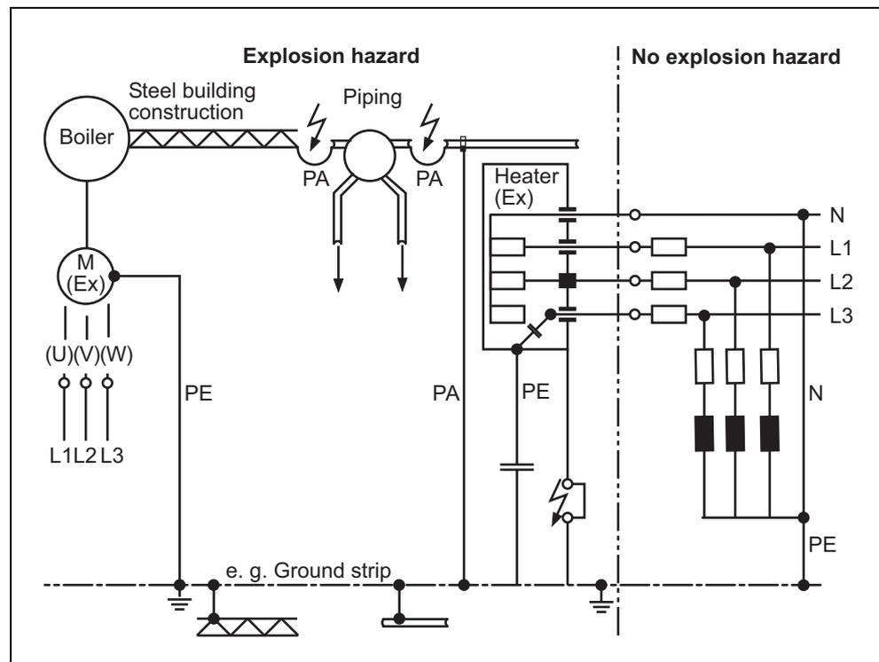
Fig. 14 Equipotential bonding in a hazardous area
