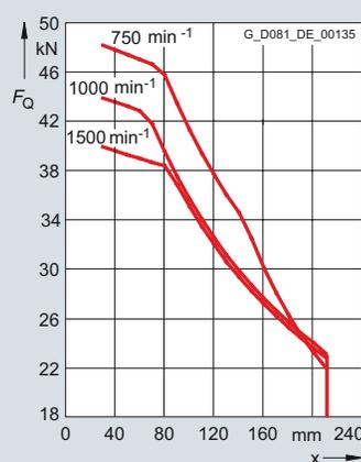
La carga radial admisible a 60 Hz tiene que reducirse al 80 %.
