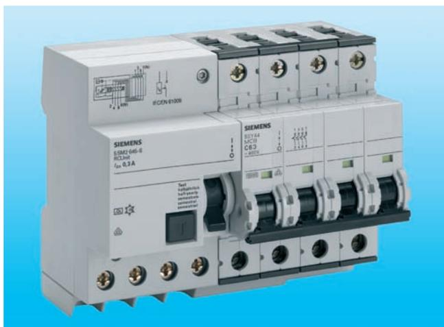
Los dos elementos se unen encastrándolos sin herramientas. Luego de ajustar los tornillos de unión de los conductores entre el bloque FI y el interruptor termomagnético con protección diferencial, estos dos aparatos forman una combinación (FI/LS).
