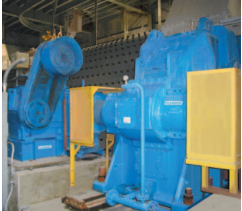
Abb.1: Zahnkranzgetriebe im Antrieb einer Zementmühle Fig. 1: Girth gear unit in the drive system of a cement mill
