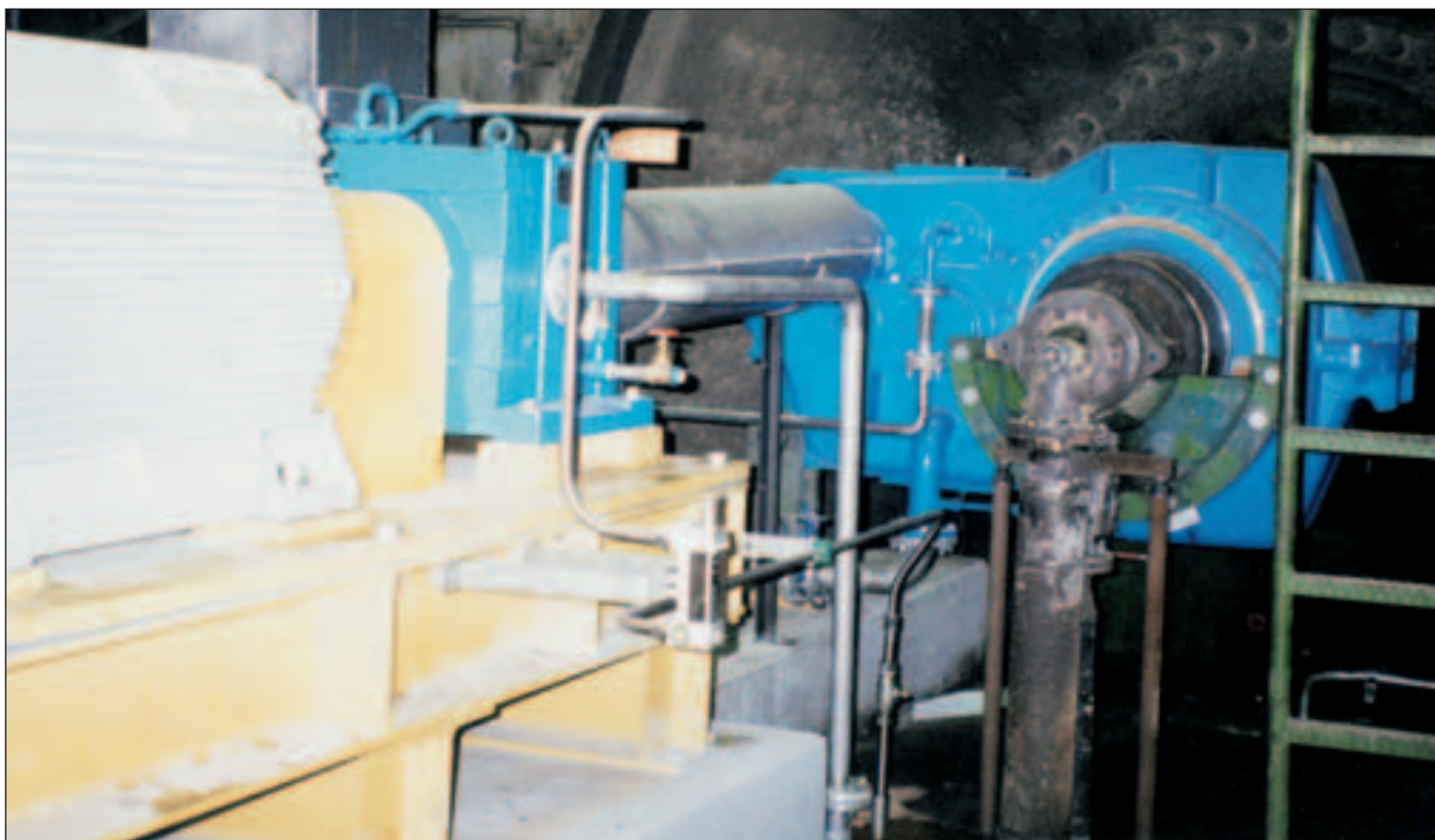
Glättzylinderantrieb mit FLENDER-Stirnradgetriebe der Bauart GHDP 585, i = 44 , Zentralschmierung, Dampfkopfhalterung, Sonntagsantrieb, KLN 250 Glazing cylinder drive with FLENDER helical gear units type GHDP 585, i = 44 , central lubrication system, steam head bracket, Sunday drive, KLN 250 Entraînement du frictionneur avec réducteur FLENDER à engrenages cylindriques type GHDP 585, i = 44 , graissage centralisé, boîte à vapeur, entraînement auxiliaire, KLN 250
