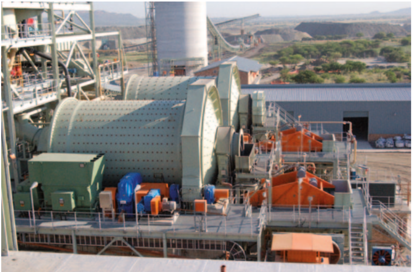
Zahnradgetriebe Bauart MDSS im Antrieb einer Rohrmühle Gear unit type MDSS in the drive system of a tube mill
