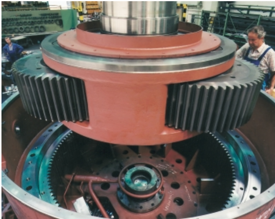
Abb. 6: Einbau der Planetenstufe in ein Kegelrad-Planetengetriebe Fig. 6: Mounting a planetary gear stage into a bevel planetary gear unit
