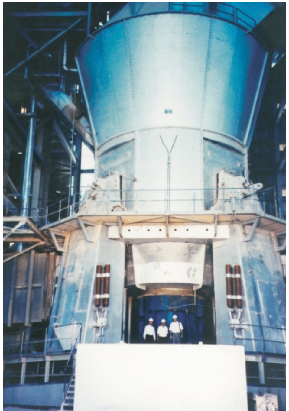
Abb. 1: Vertikalmühle mit Kegelradplanetengetriebe KMPS 715
