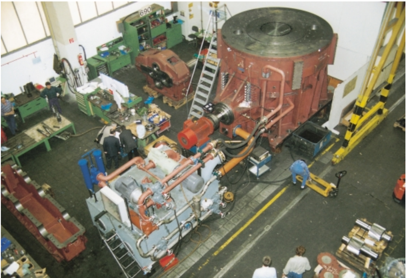
Bisher größtes geliefertes Vertikalmühlengetriebe der Bauart KMPS 755 beim Probelauf Biggest vertical mill gear unit type KMPS 755 supplied until now, during test run
