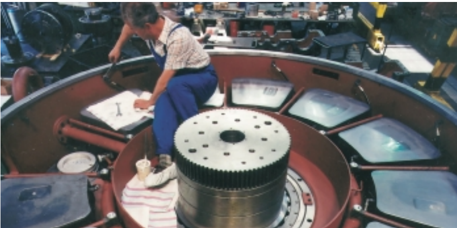
Abb. 16: Eingebautes Kippsegmentgleitlager mit hydrostatischer Schmierung Fig. 16: Mounted tilting pad thrust bearing with hydrostatic lubrication
