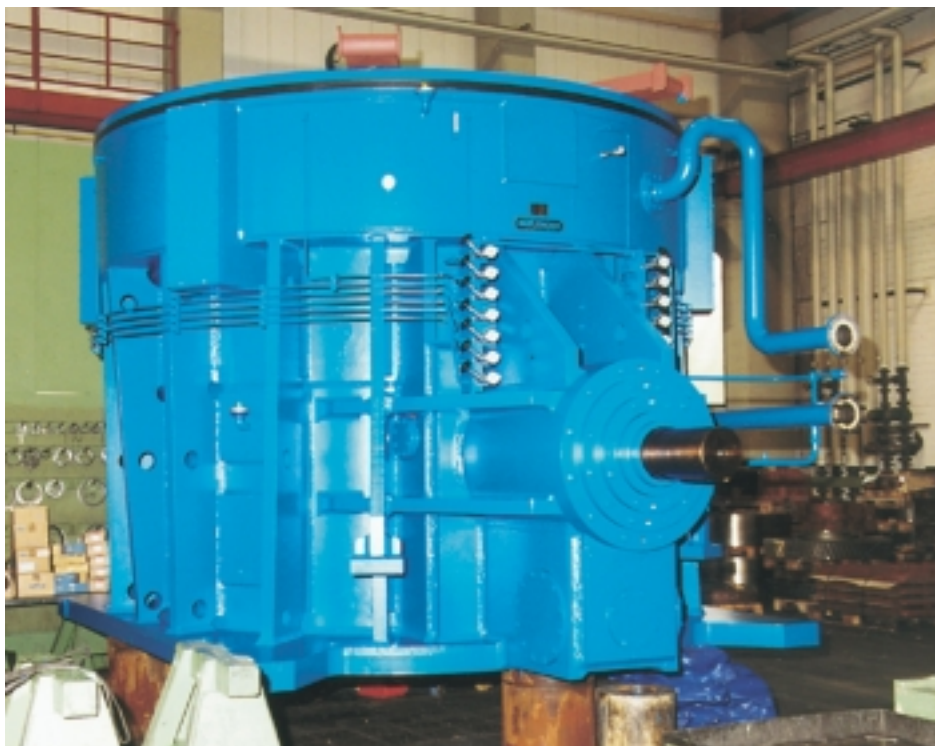
Abb. 7: Kegelrad-Planetengetriebe Bauart KMPS 715 Fig. 7: Bevel planetary gear unit type KMPS 715
