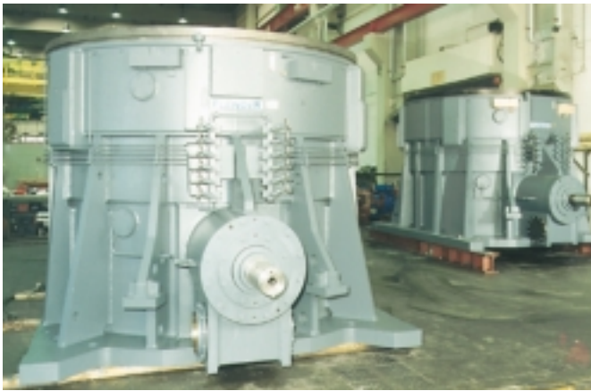
Vertikalmühlengetriebe Bauart KMP 680 nach der Montage Vertical mill gear unit type KMP 680 after assembly
