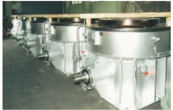
Vertikalmühlengetriebe Bauart KMP 300 vor dem Versand Vertical mill gear unit type KMP 300 in the dispatch department
