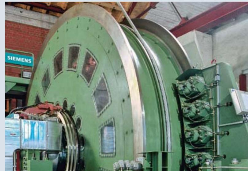
Velocidades hasta 70 km/h (44 mph), un elevado tasa de aceleración y frenada suave – SIMINE<sup>CIS</sup> Winder garantiza una operación segura y confiable para exigencias extremas.
